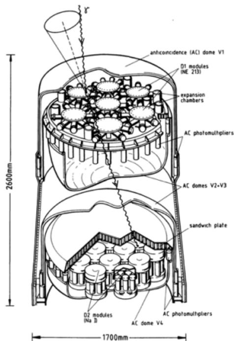
Fig: schematic of COMPTTEL.
